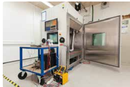
Vi har et HALT kammer i Struer, som kan forbedre produktets levetid og mindske dets fejlrate
