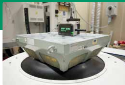
Vores Shaker System er en af de typer af testudstyr, som vi bruger til miljøtest
